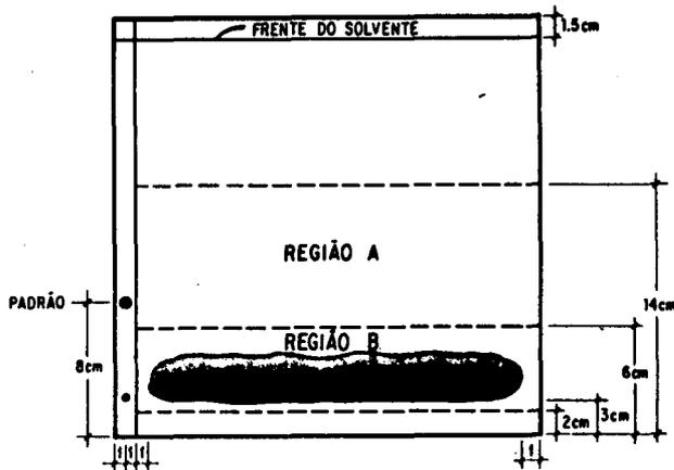
Fig. 3 – Cromatograma típico da purificação da fração de ésteres
